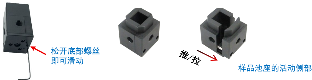
图 4-3. 样品池座的活动侧部可以推/拉移动
