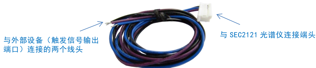
图 3-11. 外部设备触发控制连接线
