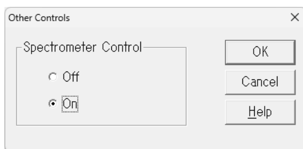
图 8-5. Model 3325 的 Spectrometer Control 的设定
