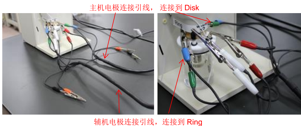
图 A-7-2-5. 双恒电位仪同步电缆的连接
