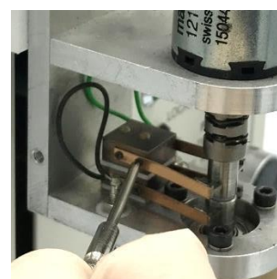
图 6-6-3. 用螺丝刀(#0)拧开损坏的银碳合金电刷上和银碳合金电刷支座连接的两个小螺丝。
