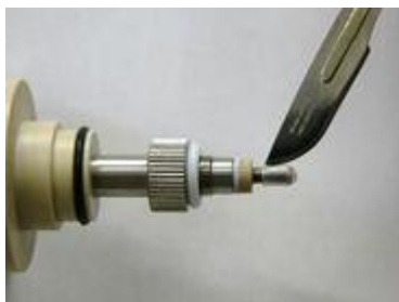
图 6-8-6. 取出顶针后，用刀切开热收缩管。
