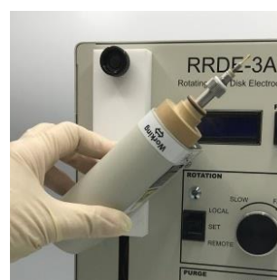
图 5-6-3. 将马达壳体旋转 180 度方向。
