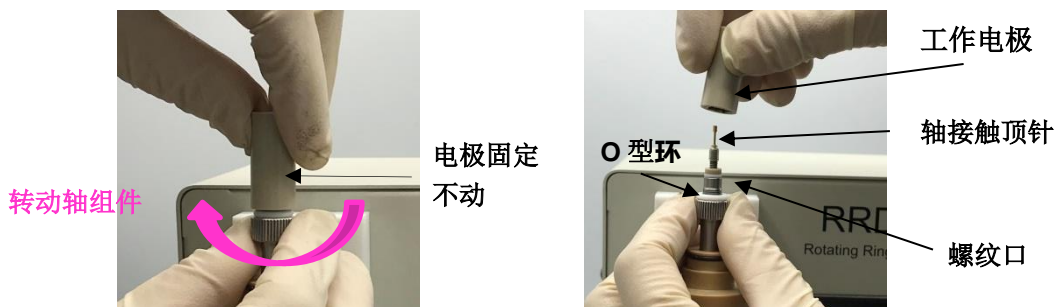
图 4-2-1. 电机轴逆时针方向缓慢转动, 细心地将工作电极拆下
