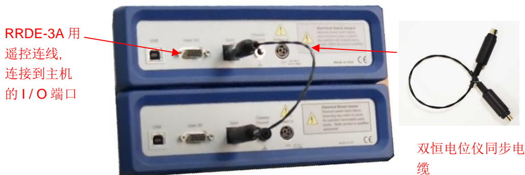
图 A-7-2-3. 双恒电位仪同步电缆的连接
