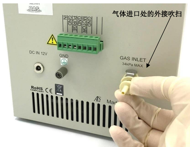
图 3-8-3-1. RRDE-3A 的气体进口连接
