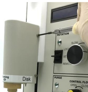
图 6-6-1.用螺丝刀(#1 或 #2)将电机组件外壳固定用的 4 个螺丝拧开。
