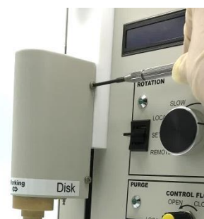
图 6-9-9. 盖上电机组件的外壳，并用螺丝刀 (#1 或 #2)将电机组件外壳的 4 个螺丝固定。
