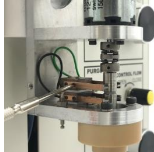
图 6-9-2. 用螺丝刀 (#0) 拆下连接四个银碳合金电刷的小螺丝。
