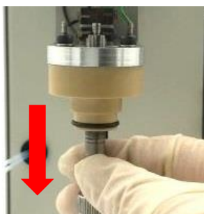
图 6-7-4. 轻轻地把轴朝下拉。如果轴有明显损坏，难以拔出，请拆下轴承组件将轴一起拔出。
