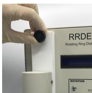
图 5-6-2. 特氟龙支座板固定在最上面的位置。
