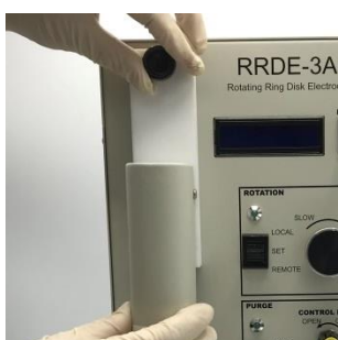
图 5-6-1. 松开 RRDE-3A 的特氟龙支座板上的旋钮，将电机组件向上移动。
