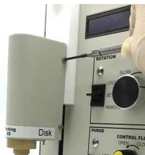
图 6-7-8. 盖上电机组件的外壳，并用螺丝刀 (#1 或 #2) 将电机组件外壳的 4 个螺丝固定。
