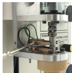
图 6-7-6. 用螺丝固定 4 个银碳合金电刷。
