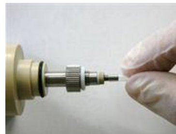
图 6-8-8. 在轴组件的尖端处换上新的热缩管。
