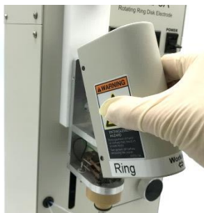
图 6-6-2.拆下电机组件的外壳。
