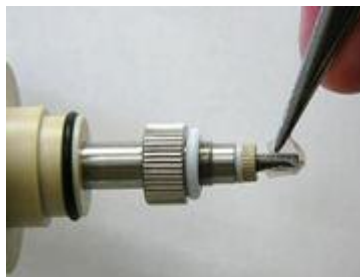
图 6-8-7. 剥开取下旧热收缩管
