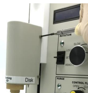
图 6-6-6. 盖上电机组件的外壳,并用螺丝固定。
