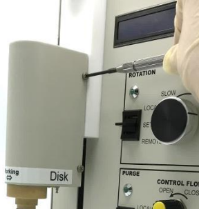
图 6-9-1. 用螺丝刀 (#1 或 #2) 将电机组件外壳固定用的 4 个螺丝拧开，拆下电机外壳。
