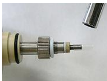
图 6-8-9. 用热枪或吹风机(150 摄氏度)将收缩管加热收缩包在轴上。
