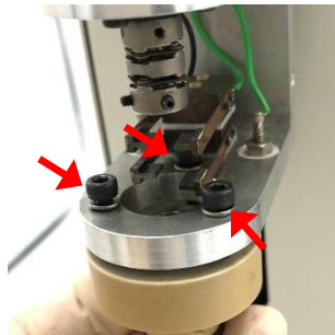
图 6-9-4. 用六角扳手 (2.5 mm) 松开铝框和轴承之间连接的三个固定螺钉，取下轴承组件。
