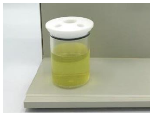
图 3-9-2. 将 RRDE-3A 特氟龙杯盖盖到池杯上。
