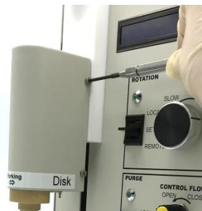
图 6-7-1. 用螺丝刀 (#1 或 #2) 将电机组件外壳固定用的 4 个螺丝拧开。
