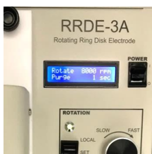
图 6-6-7. 为使新银碳合金电刷和轴之间能有良好接触, 请先将转速设定在 8000 rpm, 然后运行 10 分钟, 这样可减少银碳合金电刷和轴之间的接触电阻, 并能降低旋转过程中的噪音。
