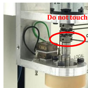
图 6-9-3. 用六角扳手 (0.89mm= 0.035 英寸) 将弹性联轴器下侧的两个六角螺丝松开，同时用另一只手握住轴的下方。
