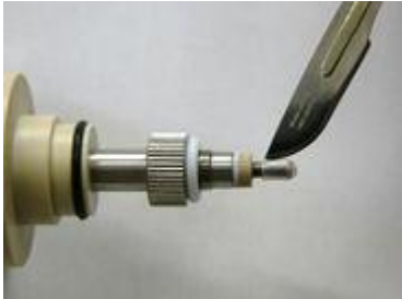
图 6-8-6. 取出探头后，用刀等工具在热缩管上划开一道口子。
