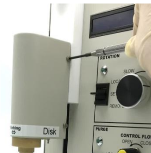
图 6-6-1. 用螺丝刀 (#1 或 #2) 将电机组件外壳固定用的 4 个螺丝拧开。
