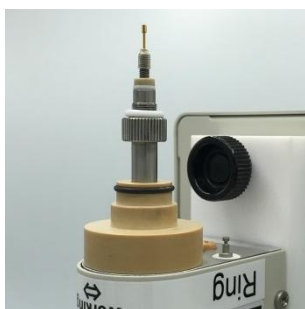
图 5-6-4. 现在轴接触顶针的位置在顶部。顶针相当尖锐，须小心操作。RDE 或 RRDE 电极就安装在这里。
