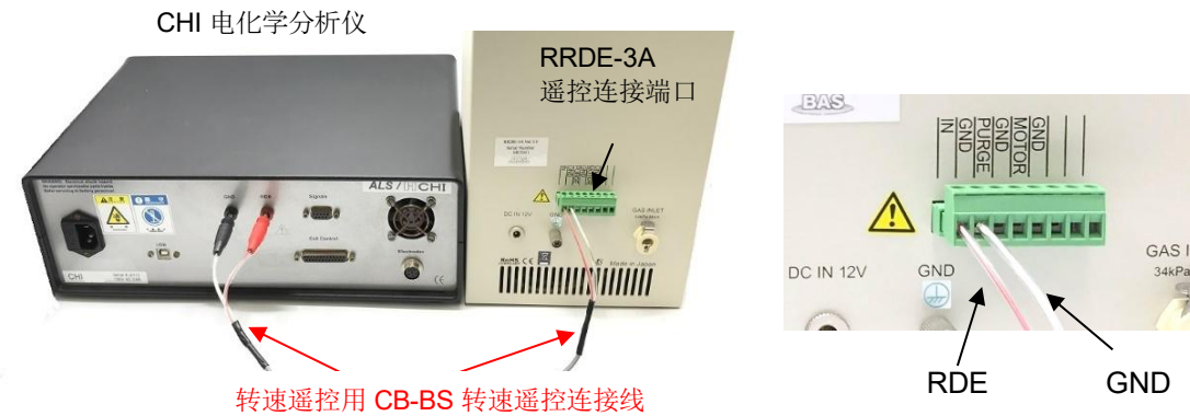
图 A-7-1-2. CHI 电化学分析仪和 RRDE-3A 之间的转速遥控连接
