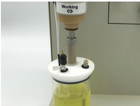
图 3-9-4. 特氟龙杯盖上开有 6 个孔。这些孔用于参比电极，对电极，工作电极，吹扫气管的设置。将电极放置在最方便的位置。最后一个孔是气体的出口。
