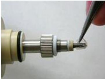
图 6-8-7. 剥开取下旧热收缩管
