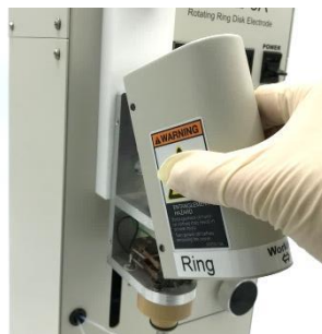
图 6-6-2. 拆下电机组件的外壳。
