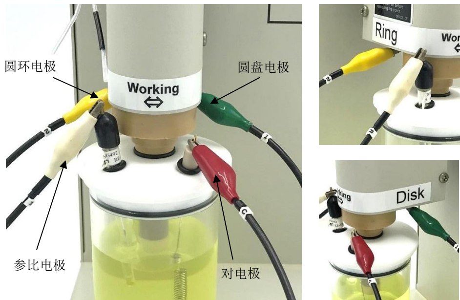
图 3-8-2-1. 电极与对应引线的连接
