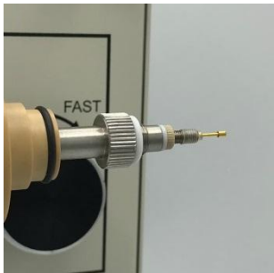
图 6-8-4. 把新的顶针插入轴的孔中。
