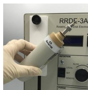
图 5-6-3. 将马达壳体旋转 180 度方向。
