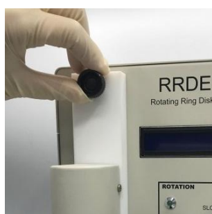
图 5-6-2. 特氟龙支座板固定在最上面的位置。
