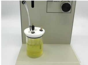
图 3-9-3. 参比电极，对电极和吹扫气管插入杯盖上对应的孔中固定。
