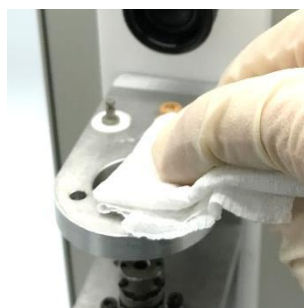
图 6-9-5. 将电机组件整体旋转 180 度，用棉签或纸擦拭铝框架的底部。
