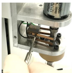
图 6-6-5. 用刚才拆下的两个小螺丝固定新银碳合金电刷, 并确认位置正确。
