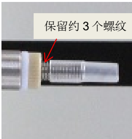
图 6-8-9. 请将管子套在轴上，直到轴尖露出大约三圈螺纹为止。(如果套管过紧难以安装，请一边用手配合轴上的螺纹旋转，一边将其插入。)
