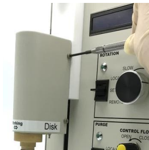
图 6-9-9. 盖上电机组件的外壳，并用螺丝刀 (#1 或 #2)将电机组件外壳的 4 个螺丝固定。
