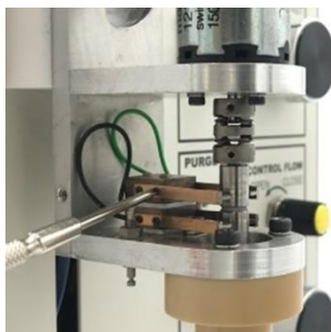
图 6-7-2. 用螺丝刀 (#0) 拆下连接四个银碳合金电刷的小螺丝。
