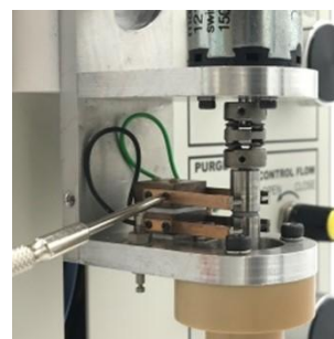
图 6-7-6. 用螺丝固定 4 个银碳合金电刷。
