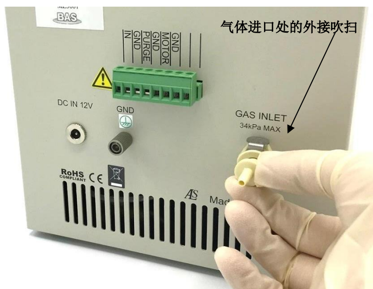
图 3-8-3-1. RRDE-3A 的气体进口连接
