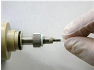
图 6-8-8. 在轴组件的尖端处换上新的热缩管。
