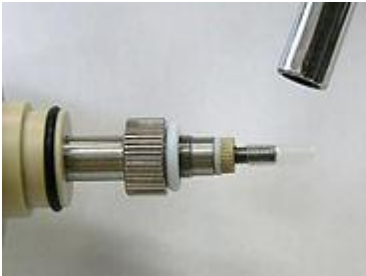
图 6-8-10. 用热枪或吹风机(150 摄氏度)将收缩管加热收缩包在轴上。
