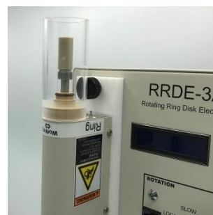
图 5-6-6. 旋涂实验准备就绪。将需要旋涂的样品滴在 RDE 或 RRDE 电极上。电机旋转几分钟，然后一个恒定膜厚的化学修饰电极制备完成。
