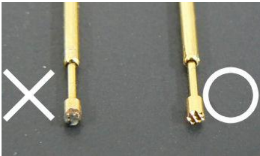
图 6-8-1. 左边是被腐蚀了的轴接触顶针。
