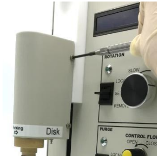
图 6-7-8. 盖上电机组件的外壳，并用螺丝刀 (#1 或 #2) 将电机组件外壳的 4 个螺丝固定。
