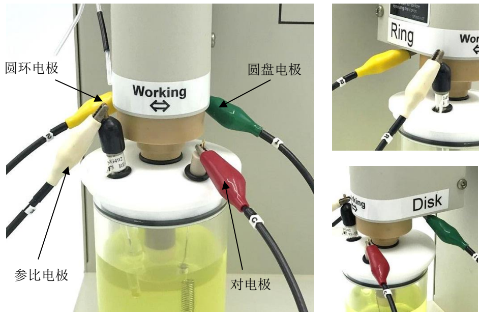
图 A-7-1-5. 电极引线连接
