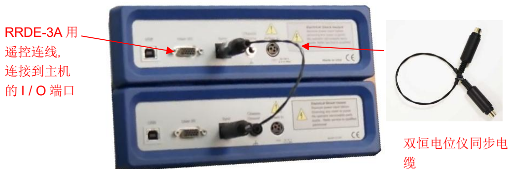
图 A-7-2-3. 双恒电位仪同步电缆的连接
