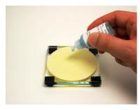
1.准备好玻璃板,贴上金刚砂抛光垫,先用蒸馏水湿润。 然后将金刚砂抛光液摇匀后, 滴几滴在抛光垫上。
