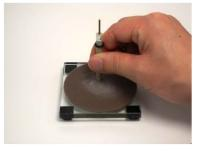
3. 将玻璃板上的金刚砂抛光垫换成氧化铝抛光垫,用蒸馏水 湿润后,用手指(戴上干净的实验用手套)用刮去多余的水 分。将氧化铝抛光液摇匀后,滴几滴在氧化铝抛光垫上。 将电极垂直放在抛光垫上,画"8"字或画圆进行打磨抛光 直到电极表面呈镜面状。用蒸馏水冲洗电极表面,在空气 中干燥后待用。
