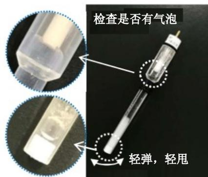
**注意:** 如果经过一段时间的使用后, 电极主体(a)的前端没有浸到内部溶液而露出液面的话, 请将电极主体(a)拧开取下将饱和硫酸钾溶液注入RE-2CP支架管(b), 直到电极主体前端能浸入到内部溶液中(如右图所示)。
