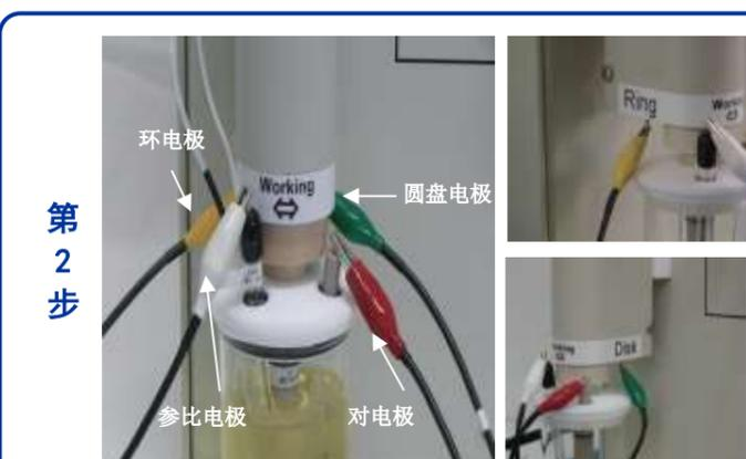
将工作电极浸入到溶液中。如果必要的话，插上吹扫气管(带黑色标签的气管出口应位于溶液表面上方，另一根气管应插入溶液接近杯底部的位置)。
