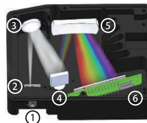
光谱仪内部光学结构示意图
